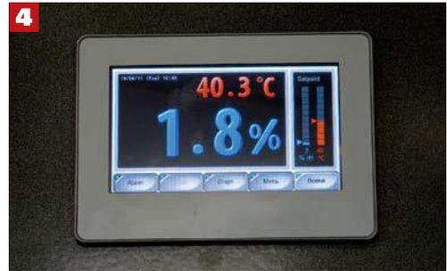
**1** Am Anfang steht ein Bad in Salzwasser: 90 Sekunden bei 300 Volt und 250 Ampere. **2** Anschließend werden per Alkohol Wasserreste entfernt und die Teile getrocknet. **3** Danach sind die Kupferkontakte klinisch rein. **4** Im Klimaschrank warten sie bei definierten Bedingungen auf ihre Goldbeschichtung.
