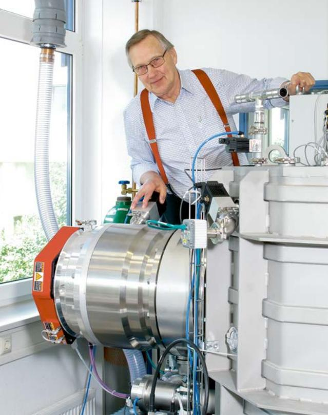
**WBT-Inhaber Wolfgang B. Thörner inspiziert die mit mehr als 100.000 Touren pro Minute rotierende Turbomolekularpumpe, die das Vakuum erzeugt.**
